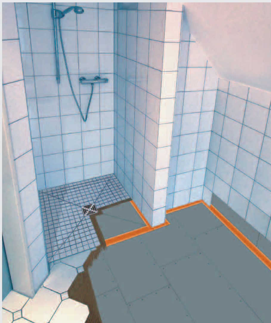
Fig. 7 : Le revêtement des sols peut être réalisé avec des Plaques de sol fermacell . On trouvera de plus amples informations dans la brochure « Plaques de sol fermacell – Des solutions, systèmes pour tous les types de sol ».
