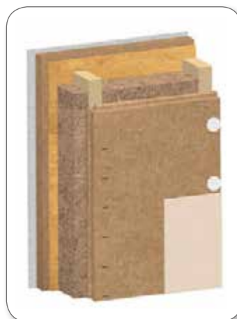
Façade en crépi avec niveau d'installation
