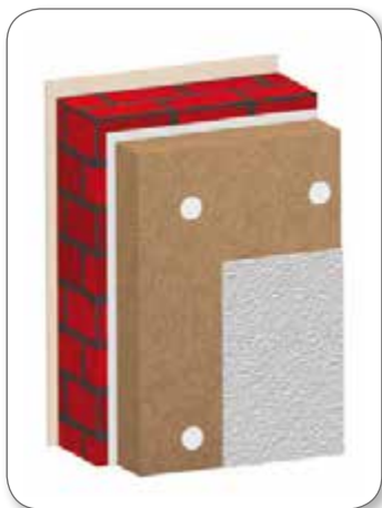
Façade en crépi
