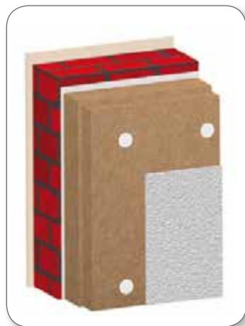
Façade en crépi en deux couches
