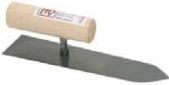
Edelstahl, geschmiedet, feines und biegsames Blatt. Blattstärke 0,8 mm. Kelle zum Aufziehen von Lehm-Oberputz fein sowie CLAYFIX Struktur- und Feinputzen und zum Verteilen des Mörtels auf der Putzfläche. Auch zum Vorbereiten der Putzfläche für geriebene und geschwammte Oberflächen. Auch zum Glätten grober Lehmputze.
