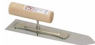
Edelstahl gewalzt, schmales Blatt mit kräftiger, ausgerundeter Rückenverstärkung und aufgesetztem Steg. Blattstärke 0,5 mm. Kelle für das Aufziehen von Lehm-Oberputz fein sowie CLAYFIX Struktur- und Feinputzen und zum Verteilen des Mörtels auf der Putzfläche. Auch zum Vorbereiten der Putzfäche für geriebene und geschwammte Oberflächen sowie zur Endbearbeitung geglätteter Oberflächen. Auch zum Glätten grober Lehmputze.
