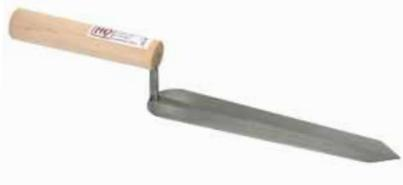
Edelstahl gewalzt, konisches Blatt. Blattstärke 1,0 mm. Kelle für den Verputz teilverdeckter Flächen, z. B. hinter Ziergittern, Heiz-Radiatoren und Heiz-Rohrregistern. Hervorragend geeignet für schwer zugängliche Putzflächen in Anschlussbereichen.
