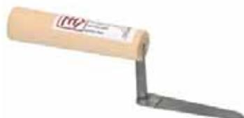
Hon-yaki Stahl gewalzt, abgesetzt, konisches Blatt mit spitzem Abschluss. Blattstärke 0,3 mm. **Biegsame Kelle für das Beischieben von Arbeitsspuren in weitgehend fertig gestellten geglätteten Lehmputzoberflächen.** Auch für den Materialauftrag auf Kleinstflächen bei Zierputz-Arbeiten. Geeignet für Lehm-Oberputz fein sowie für CLAYFIX Struktur- und Feinputze.
