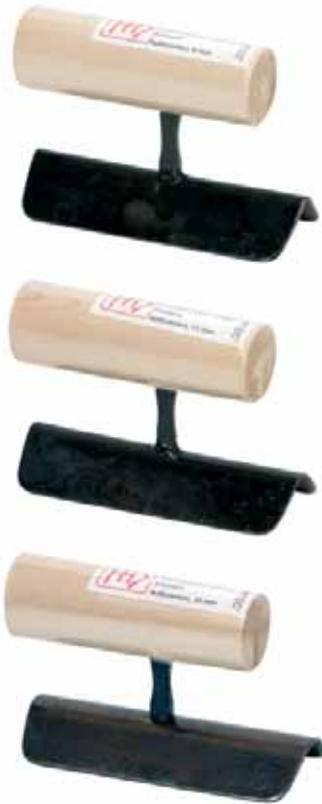
Edelstahl, geschmiedet, abgewinkeltes Blatt 90°, gleichschenkelig. Nakakubi-Ausführung (= Griff mittig). Blattstärke 2,0 mm. Kelle für die Ausführung von Graten mit definierter Viertelkreisrundung. Geeignet für Lehm-Oberputz grob und fein sowie für CLAYFIX Struktur- und Feinputze.
