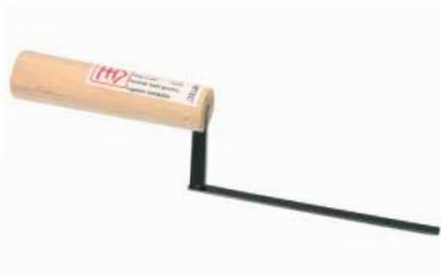
Hon-yaki Stahl geschmiedet. Blattstärke 1,0 - 3,5 mm. Fugeisen mit robustem Blatt für die Ausführung von Verzierungen, Begleitstreifen und gradlinigen Dekoren in Lehmputzflächen in Hohlkehlen-Form. Auch für die Ausführung konkaver Fugen im Lehmstein-Mauerwerk.
