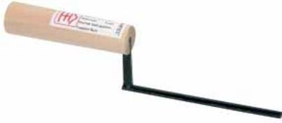
Hon-yaki Stahl geschmiedet. Blattstärke 2,0 - 3,0 mm. Fugeisen mit robustem Blatt für die Ausführung von Verzierungen, Begleitstreifen und gradlinigen Dekoren in Lehmputzflächen. Auch für die Ausführung facher Fugen im Lehmstein-Mauerwerk.
