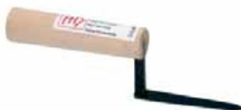
Hon-yaki Stahl geschmiedet, unterseitig rund, konisches Blatt mit spitzem Abschluss. Blattstärke 1,0 - 2,0 mm. **Robuste Kelle für das freihändige Ausformen von Kehlen, z. B. bei umputzten Decken- und Wandbalken sowie „Kölner-Decken“.** Geeignet für Lehm-Oberputz grob und fein sowie für CLAYFIX Struktur- und Feinputze.
