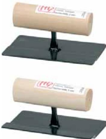
Edelstahl geschmiedet, Blatt mit aufgesetztem Streifen (2 mm) oder angesetztem Winkel (5 mm). Ansatzbreite 20 mm. Nakakubi-Ausführung (= Griff mittig). Blattstärke 2,0 mm. Kelle für die Ausführung von scharfkantigen Putzfaschen mit definiertem Vorsprung. Geeignet für Lehm-Oberputz grob und fein sowie für CLAYFIX Struktur- und Feinputze.
