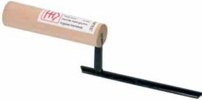
Hon-yaki Stahl geschmiedet. Blattstärke 1,0 mm. Fugeisen mit robustem Blatt für die Ausführung von Verzierungen, Begleitstreifen und gradlinigen Dekoren in Lehmputzflächen in Viertelstab-Form. Auch für die Ausführung konvexer Fugen im Lehmstein-Mauerwerk.
