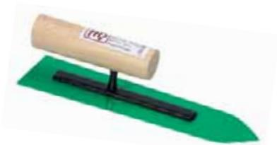
Erfolgsmodell: Kunststoff, weiches und biegsames Blatt. Blattstärke 1,0 mm (grün) und 2,0 mm (blau). Rückenverstärkung Metall kunststoffummantelt. **Ausschließlich geeignet für die Endbearbeitung von Lehm-Oberputz fein sowie CLAYFIX Struktur- und Feinputzen zum Erzielen besonders glatter Oberflächen.**
