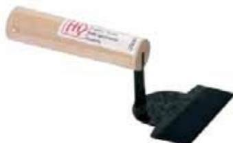
Stahl geschmiedet, rechteckiges Blatt mit halbrundem Ansatz. Blattstärke 1,0 - 2,0 mm. **Rechteckiges Blatt aus geschmiedetem Stahl mit halbrundem Ansatz. Robuste Kelle für die Ausführung ebener Oberflächen bei rechteckigen Putzflächen mit erhabenen Umgrenzungen, z. B. Putzspiegel in Holz-Rahmenwerken.** Auch für Kleinfächen bei Zierputz-Arbeiten. Geeignet für Lehm-Oberputz grob und fein sowie für CLAYFIX Struktur- und Feinputze.
