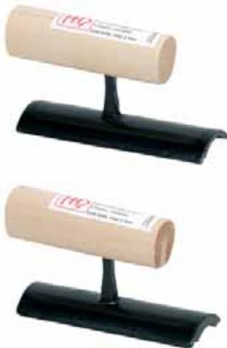
Edelstahl, geschmiedet, ausgerundetes Blatt, gleichschenkelig. Nakakubi-Ausführung (= Griff mittig). Blattstärke 2,0 mm, Einsatz für Fasenversatz 5 mm. Kelle für die Ausführung von gerundeten Graten mit Fase. Geeignet für Lehm-Oberputz grob (5 mm Fase) und fein sowie für CLAYFIX Struktur- und Feinputze.
