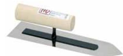
Edelstahl gewalzt, sehr feines und biegsames Blatt mit flacher, vorne abgerundeter Rückenverstärkung. Blattstärke 0,3 mm. Kelle für das Glätten und die Endbearbeitung von Lehm-Oberputz fein sowie CLAYFIX Struktur- und Feinputzen. Besonders geeignet für Lehm Glanzputzoberflächen.
