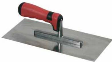
Edelstahl, rostfrei, poliert. Blattstärke 0,7 mm. Aluminiumstütze. Ergonomisch geformter Softgriff. **Großflächiger Glätter für das Aufziehen von Lehm-Unterputz und Lehm-Oberputz grob und fein. Auch zum Verteilen von angeworfenem oder angespritztem Mörtel auf der Putzfläche sowie zur Egalisierung der Putzmasse.**
