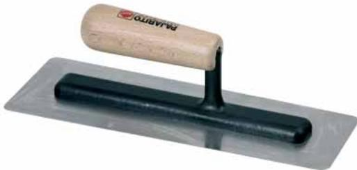
Spezialstahl, mit abgerundeten Blattecken und absolut gratfrei polierten Kanten. Blattstärke 0,6 mm. Glasfaserverstärkte Kunststoffstütze und unlackierter Holzgriff. **Robuste Kelle für das Aufziehen von Lehm-Oberputz fein sowie CLAYFIX Struktur- und Feinputzen und zum Verteilen des Mörtels auf der Putzfläche. Auch zum Vorbereiten der Putzfläche für geriebene und geschwammte Oberflächen sowie zur Endbearbeitung geglätteter Oberflächen. Auch zum Glätten grober Lehmputze.**
